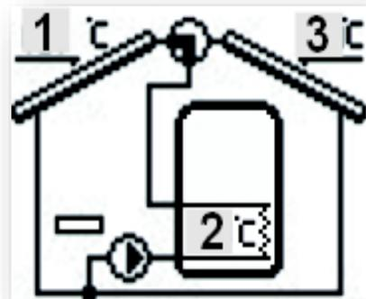
**IV.a.5) Schéma 5/17 – ohřev kotlem**
