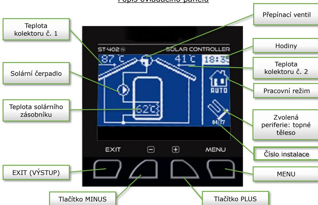
Regulátor se obsluhuje pomocí tlačítek. Vstup do menu a potvrzení volby se provádí stiskem tlačítka MENU. Pomocí tlačítek PLUS a MINUS se uživatel pohybuje mezi funkcemi v menu. Pro potvrzení vybrané pozice je třeba stisknout tlačítko MENU. Pro přechod k hlavnímu zobrazení (nebo na vyšší úroveň menu) je třeba použít tlačítko EXIT. Podobně je možné měnit všechna nastavení.
