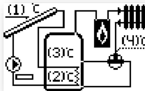
V této instalaci regulátor řídí přepínací ventil návratové vody (zpátečky) ÚT. Ventil přepíná směr toku vody: do horní nebo dolní části nádrže.
