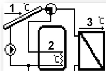
V této instalaci je zapojený kromě akumulární nádrže také tepelný spotřebič (např. bazén nebo instalace ÚT). Jeho úlohou je odběr tepelné energie, nikoliv její hromadění.
