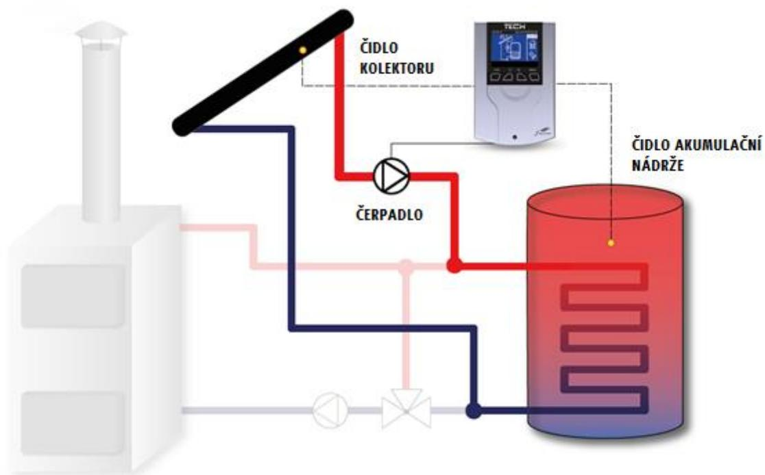
Příkladové schéma – není projektovou dokumentací. Ukazuje pouze možnosti využití regulátoru. Nejsou zde uvedeny bezpečnostní prvky topné soustavy.
